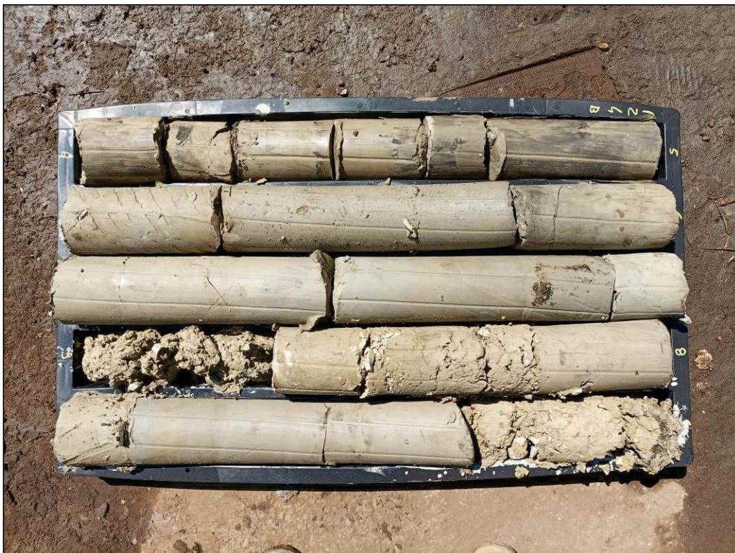
DOCUMENTAZIONE FOTOGRAFICA – PERFORAZIONE DA 5.00 A 10.00 M
