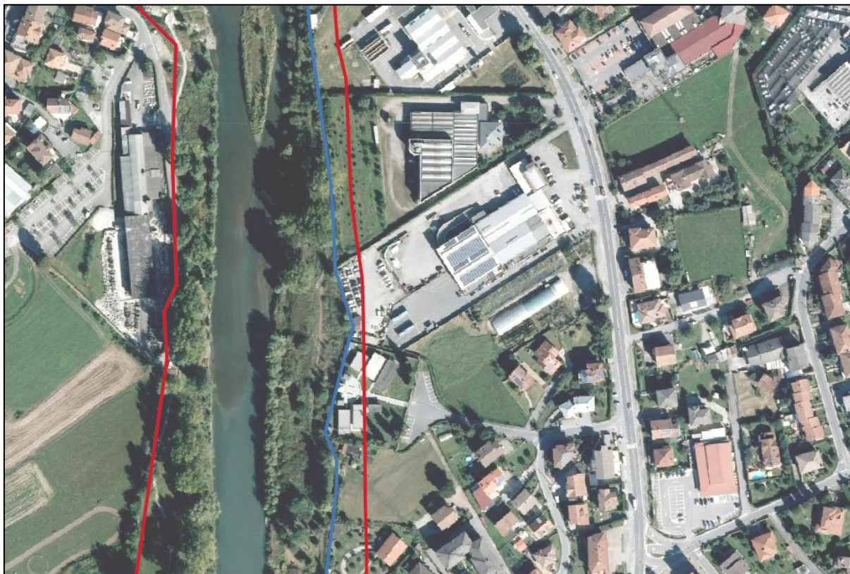
Figura 8 - Limite di fascia A derivante dalla variante PAI (in rosso) e limite tracciato su elemento morfologico certo (in blu) presso il cimitero in via delle Mercede e l'area artigianale a monte
