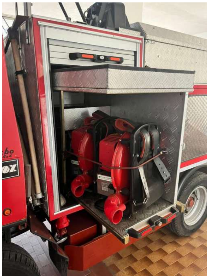
11) Particolare vano a tunnel, slitta estraibile (soffiatori non oggetto di alienazione)
