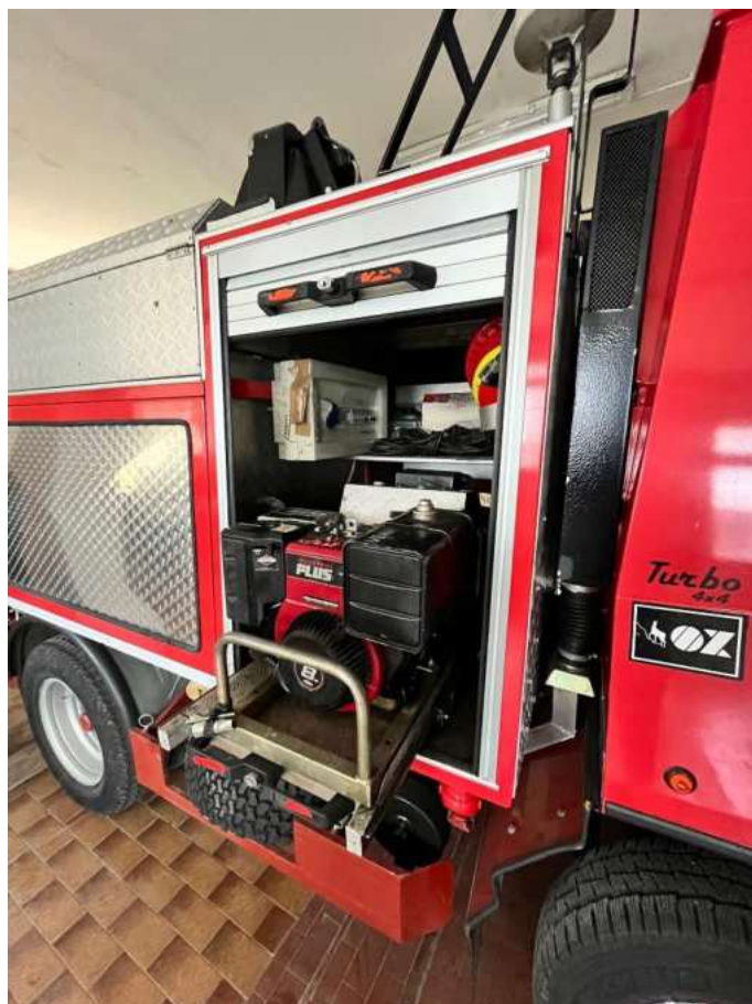
10) Particolare vano a tunnel anteriore, slitta estraibile e generatore
