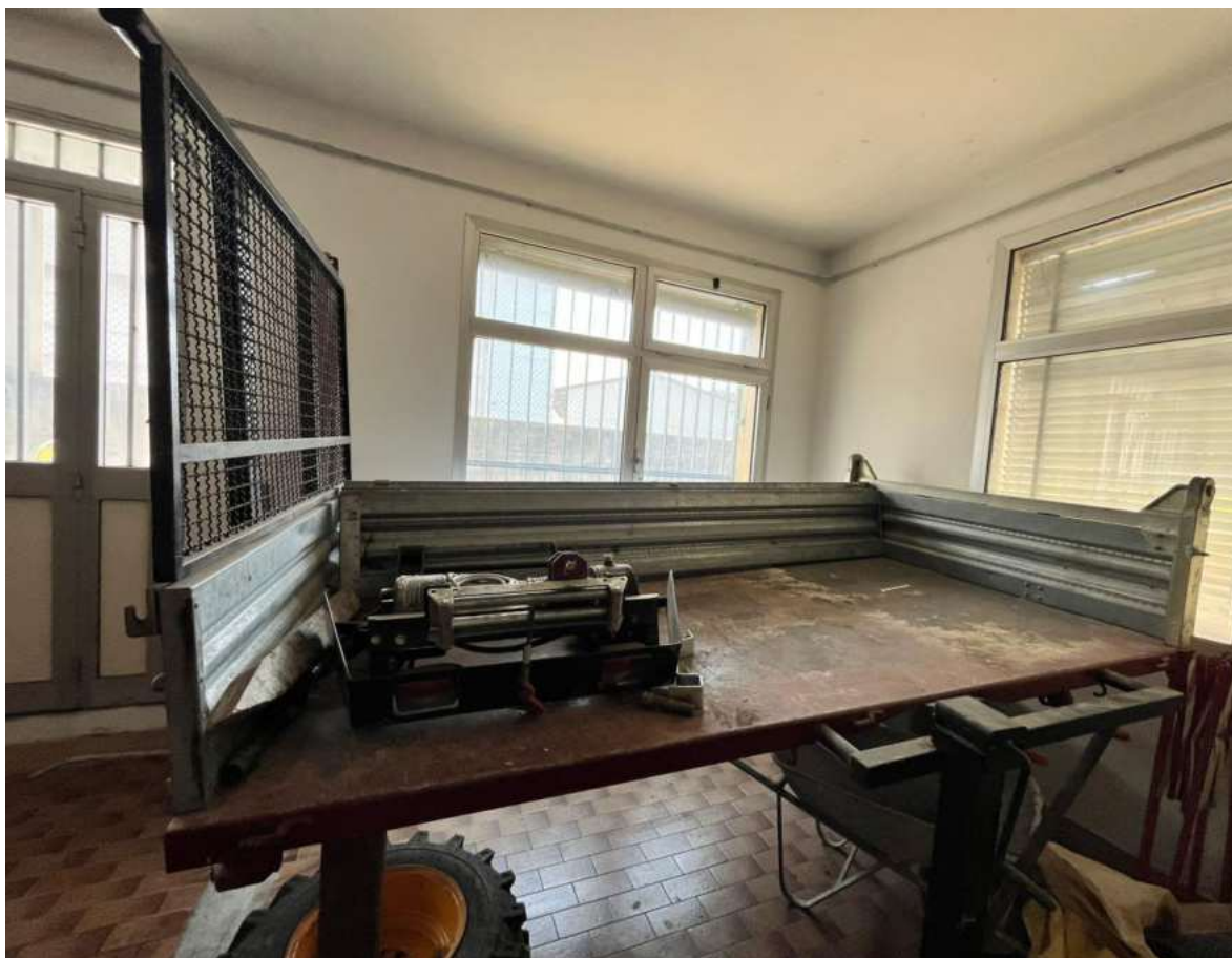
15) Cassone ribaltabile trilaterale e piedini di supporto. Verricello
