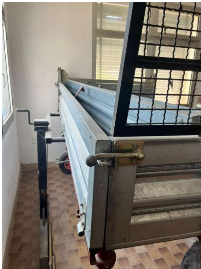
16) Particolare sponde cassone ribaltabile trilaterale e piedino di supporto
