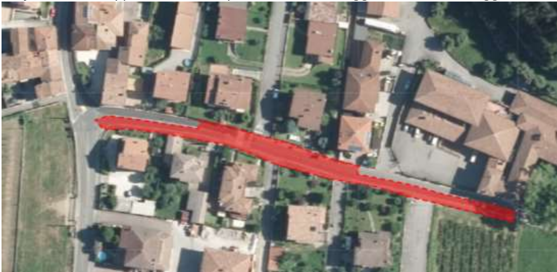
Via Fontana: fresatura + tappeto+messa in quota chiusini carreggiata, mezza carreggiata e marciapiede
