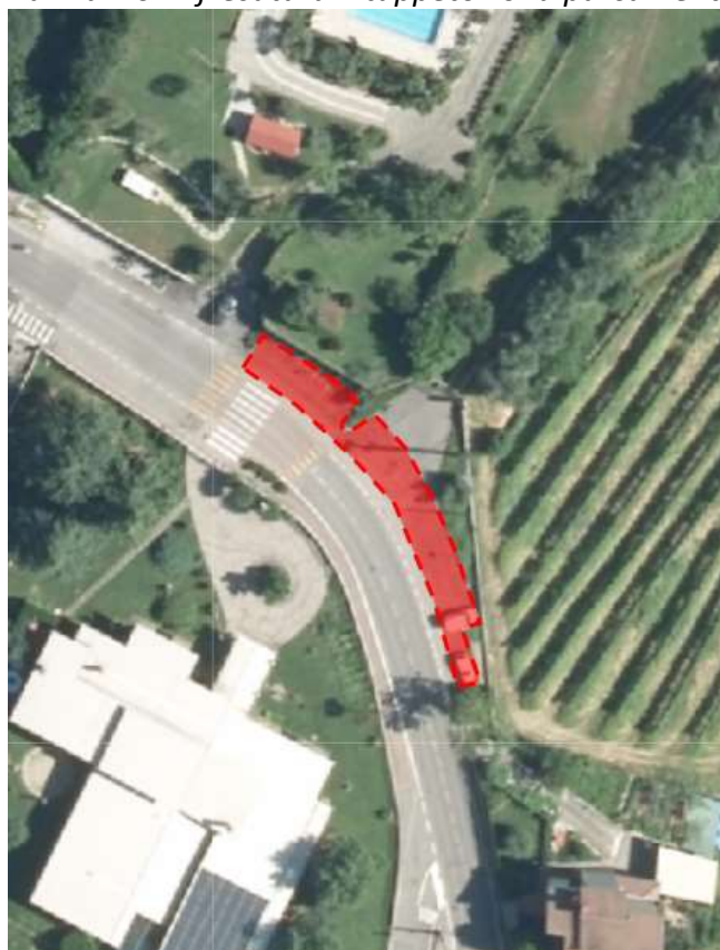
Via Manzoni: fresatura + tappeto zona parcheggio
