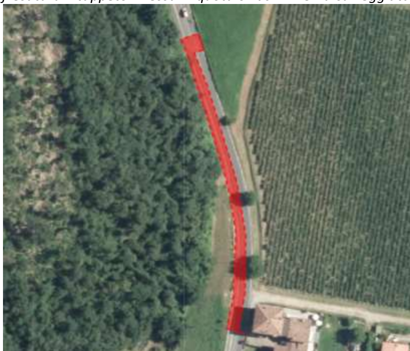
Via Manzoni: fresatura + tappeto+messa in quota chiusini mezza carreggiata e marciapiede
