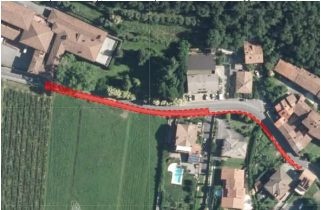
Via Fontana: fresatura + tappeto+messa in quota chiusini mezza carreggiata e marciapiede
