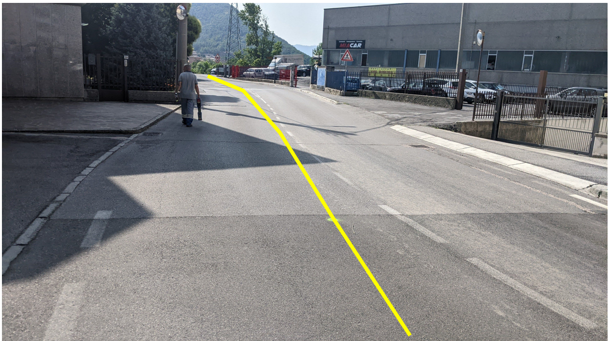
Fig. 7 Via D'annunzio: la rete SNAM lungo i sedime stradale a una profondità di 1.20 m
