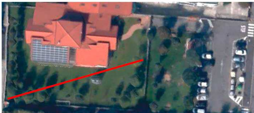
Figura 1 - stralcio planimetria con identificazione stendimento MASW
