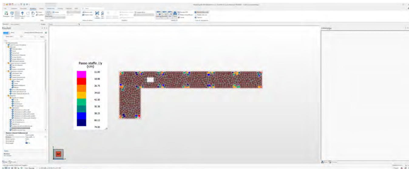
Fig. 38 – Passo delle spille a taglio a soiaio che si distribuite in direzione parallela a y
