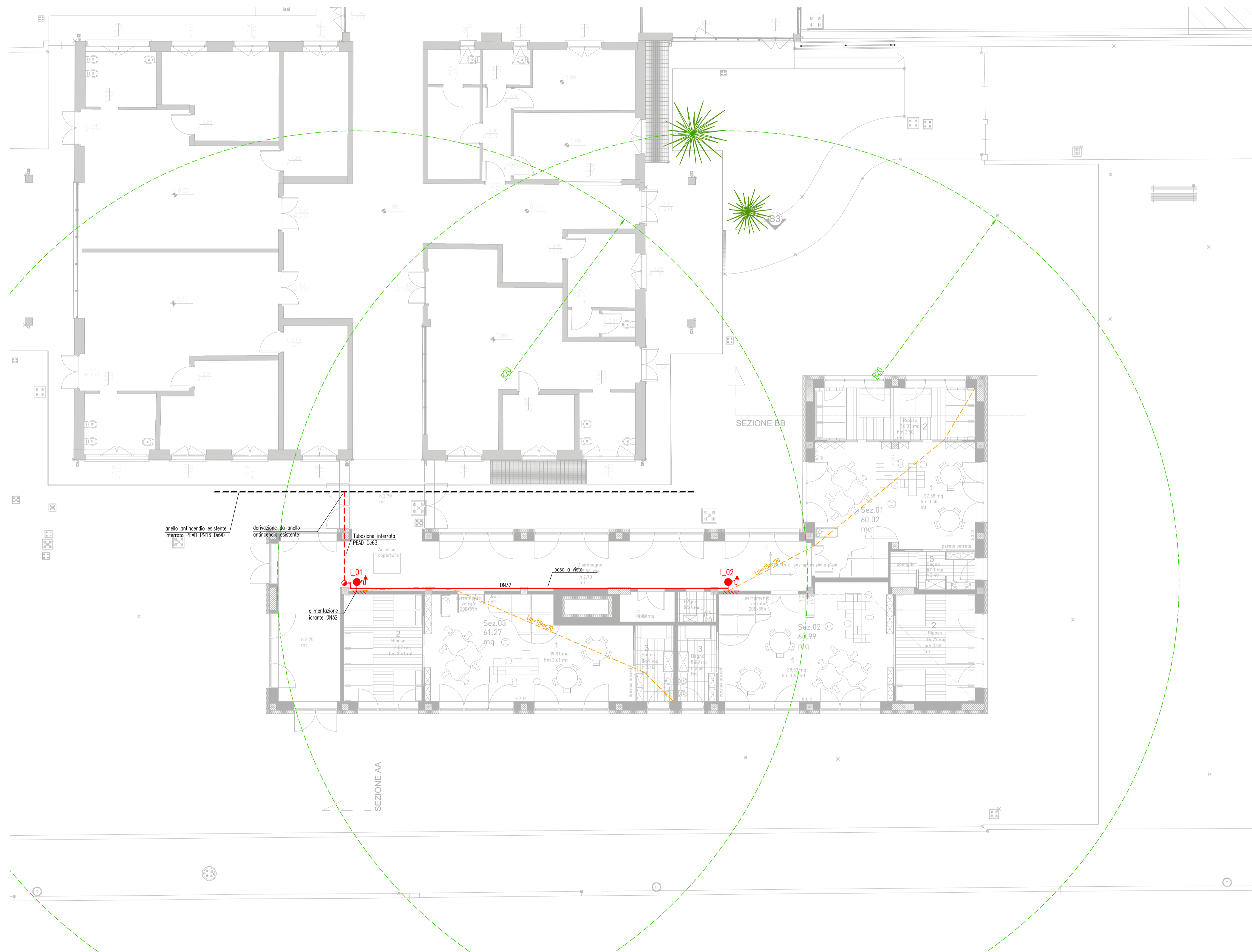
PLANIMETRIA IDRANTI UNI45 P0 - SCALA 1:100
