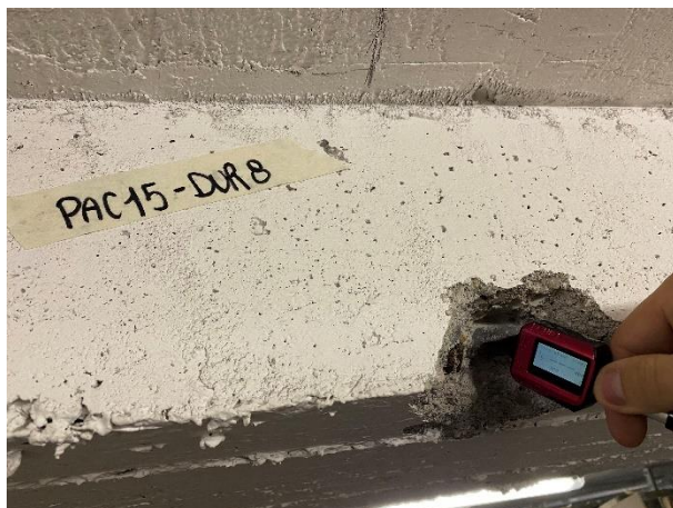
Prove con durometro su barre d'armatura
