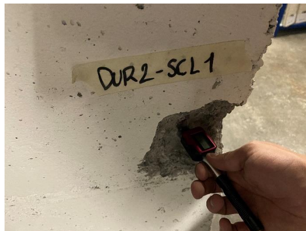
Prove con durometro su barre d'armatura
