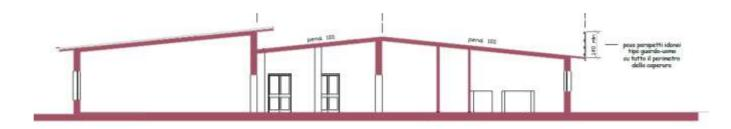
Infatti la quota del piano di calpestio del solaio in laterocemento della copertura è posto ad una altezza media da terra di 4.50 metri. Altezza gestibile con un trabattello dotatao di ruote.
