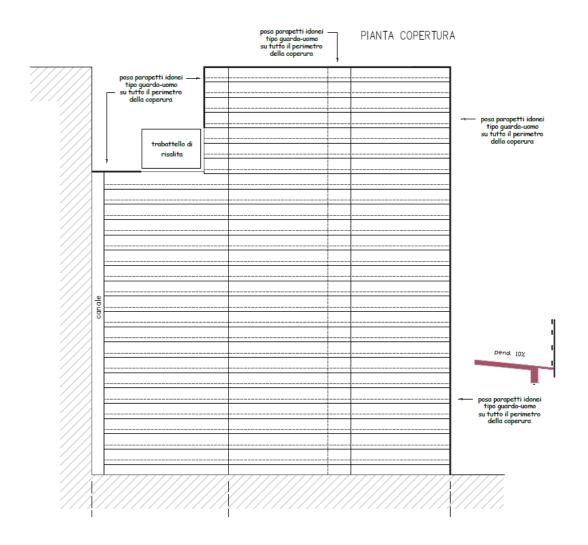
Particolare attenzione va posta alla posa dei parapetti del tipo guarda-uomo su tutto il perimetro della copertura L'installazione del parapetto può avvenire agevolmente, mediante l'utilizzo di una piattaforma elevatrice dotata di cesta oppure con un trabattello vista l'altezza limitata dell'edificio.
